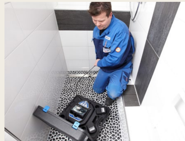
Bis 3 bar wasserdichter, robuster Farbkamerakopf mit Ø 26 mm lässt sich durch mehrere 87°-Bögen in Rohrleitungen von Ø 40 mm schieben.
